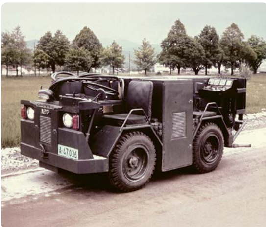
Ein AEG-Schleppfahrzeug für die Mirage-Kampffjets der Schweizer Luftwaffe.
